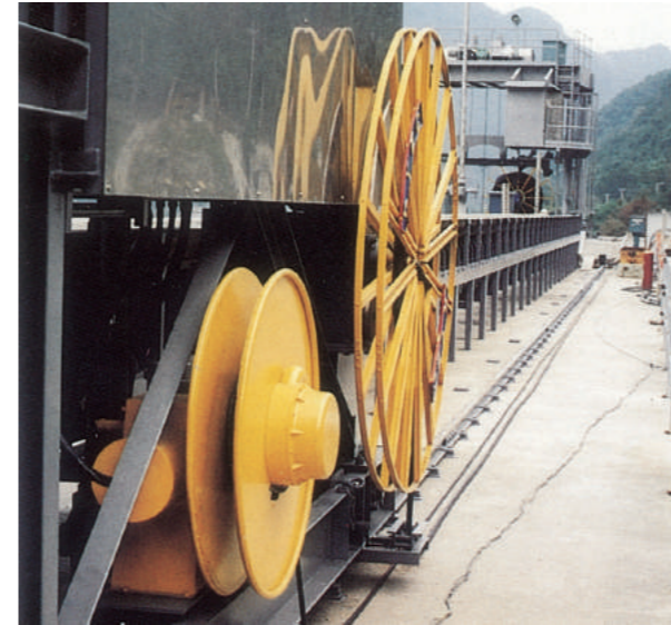
耙污機行走台車用 (天輪攔水壩)
