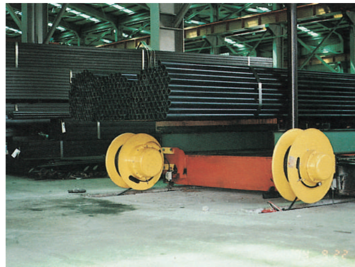
鋼管業：併排廠房 ( 橫向自走搬運台車用 )
