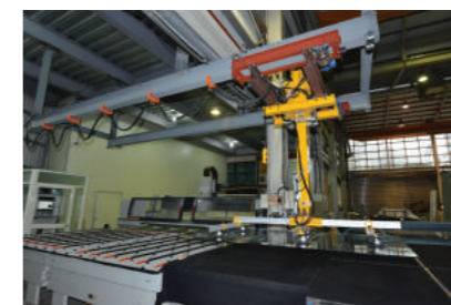
▲ 氣動平衡吊車及汽車座椅搬運治具&實際操作
