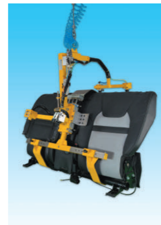
▲ 氣動平衡吊車及汽車座椅搬運治具&實際操作
